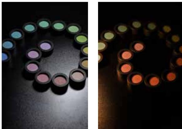
**Abb. 18.** Farbsehtest; links mit Licht welches sehr nahe an der Lichtfarbe des Tageslichts ist und rechts mit Licht welches einen sehr hohen Rotanteil enthält und so die Farbwahrnehmung sogar unmöglich macht.
